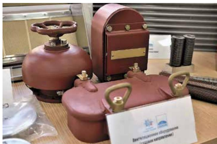
рынка составляет 2800 штук в год. Крышки вентиляционные водогазонепроницаемые прямоугольные из стали и легкого сплава также применяются в системах вентиляции и кондиционирования воздуха надводных кораблей, судов и плавсредств. Потребность — 2800 штук в год.
