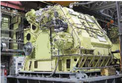
Редукторные комплексы на испытательном стенде
